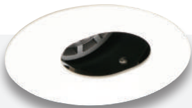
型號： LG-3548 光源：MR16 (另計) 材質：鋁製品 尺寸：W83 H38mm 嵌入孔：70mm 顏色：白色
